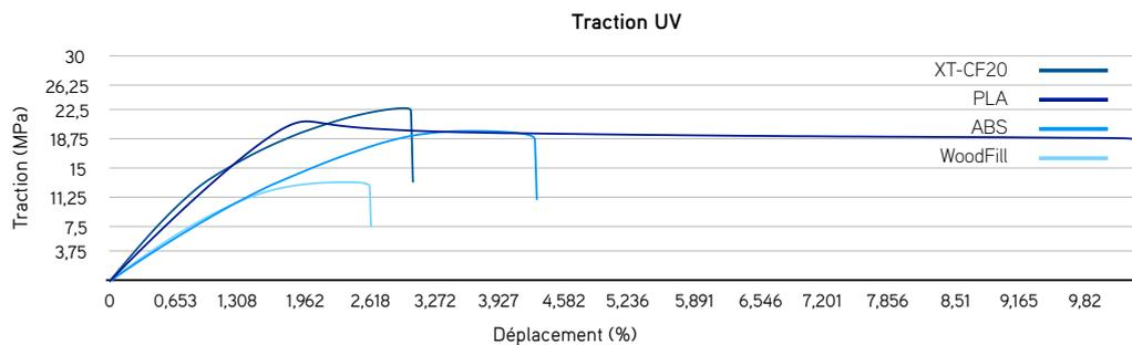
FIGURE 18 – Relevés du test de traction des éprouvettes exposées aux ultraviolets
