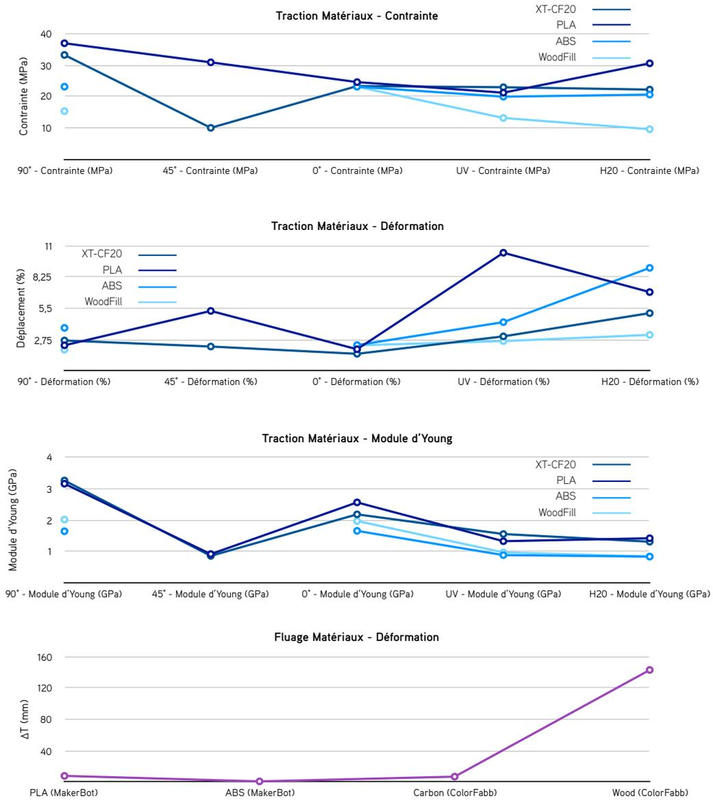
FIGURE 22 – Résumé des performances des matériaux testés
