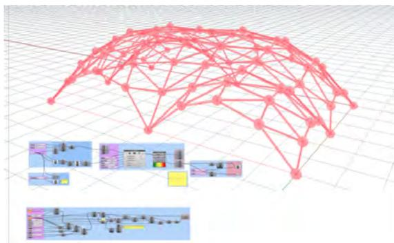
FIGURE 24 – Relaxation de la structure et génération des nœuds
