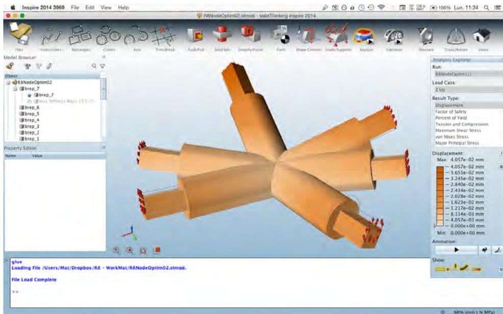
FIGURE 27 – Capture d'écran de l'application des charges (haut, charges verticales Z 100N) et simulation des déplacements suivant ces efforts (bas) dans SolidThinking Inspire
