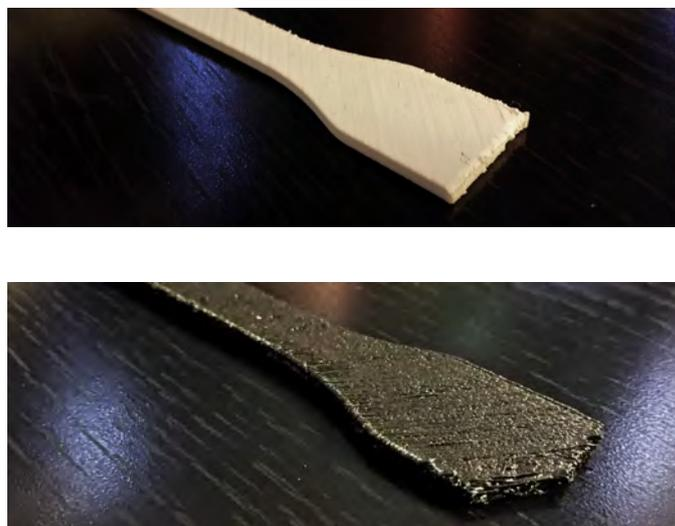
FIGURE 10 – Photo des éprouvettes PLA et fibres de Carbone (traction 45°)
