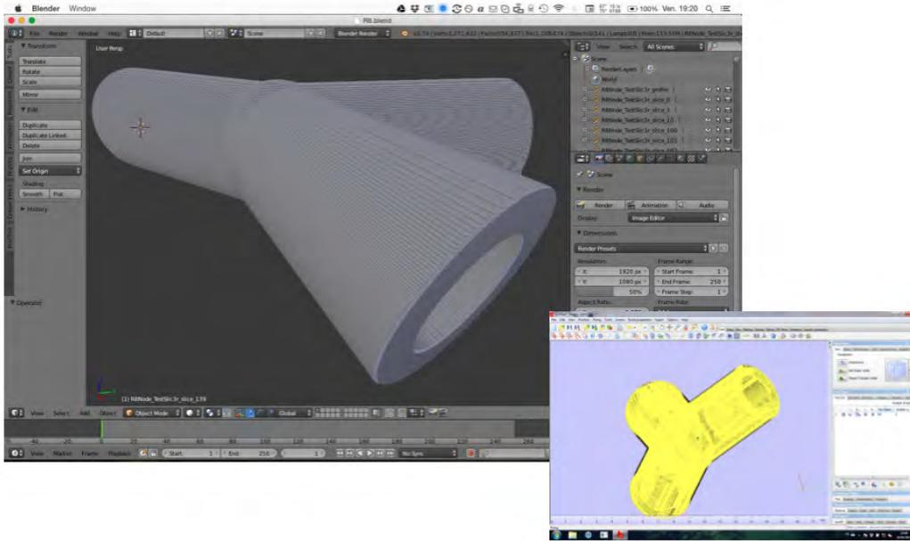
FIGURE 32 – Capture d'écran du logiciel 3D Blender (gauche), création d'un modèle 3D à partir d'un fichier Gcode. Et Magics (droite), montrant en jaune les arrêtes nécessitant des réparations géométriques
