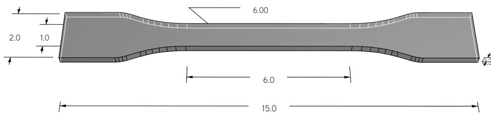
FIGURE 4 – Représentation de l'éprouvette normalisée (dimensions en mm)
