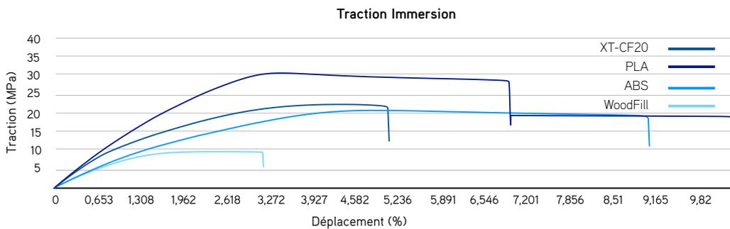
FIGURE 20 – Relevés du test de traction des éprouvettes immergées
