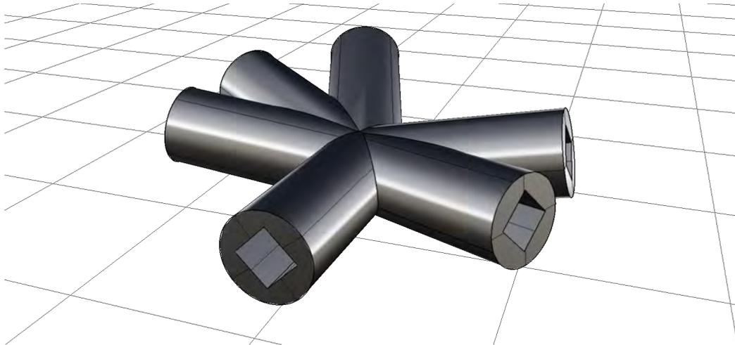
FIGURE 25 – Rendu 3D d'un nœud d'assemblage
