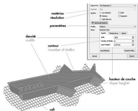
FIGURE 5 – Illustration des paramètres d'impression (LeFabShop)
