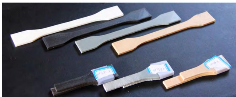
FIGURE 6 – Photo des éprouvettes avant et après rupture aux tests (traction longitudinale)
