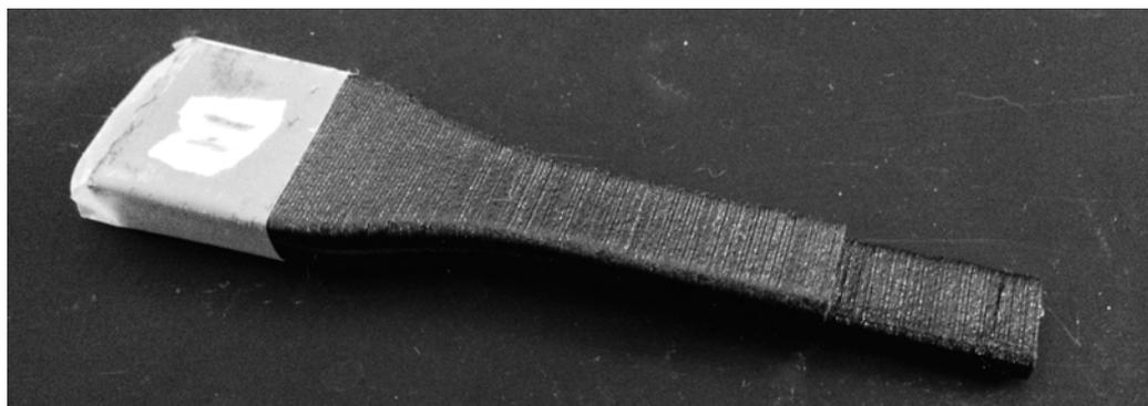
FIGURE 8 – Photo d'une éprouvette Carbone après rupture aux tests (traction transversale)
