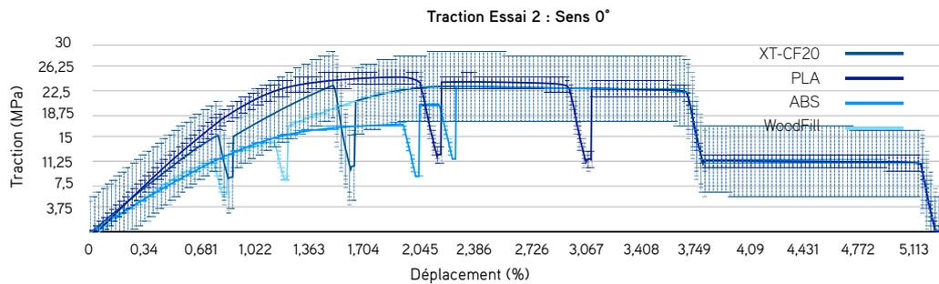
FIGURE 9 – Résultats du deuxième test de traction (traction transversale)
