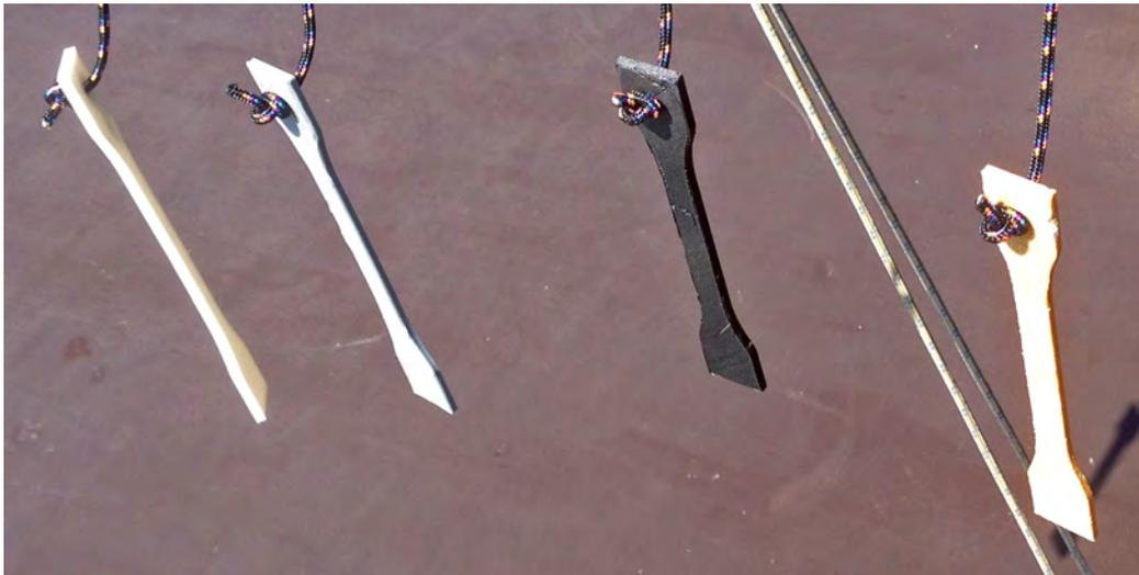
FIGURE 16 – Photo des éprouvettes exposées aux Ultraviolets
