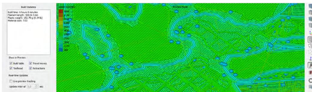
FIGURE 23 – Capture d'écran d'un détail d'une simulation de parcours d'outil (densités variables des remplissages et pourtours)
