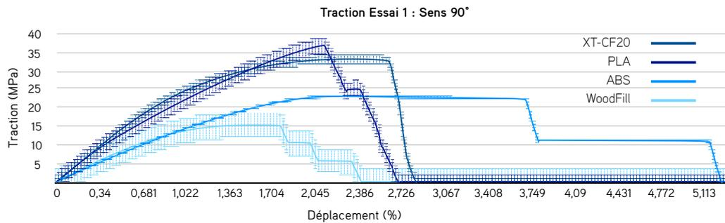
FIGURE 7 – Résultats du premier test de traction (traction longitudinale)
