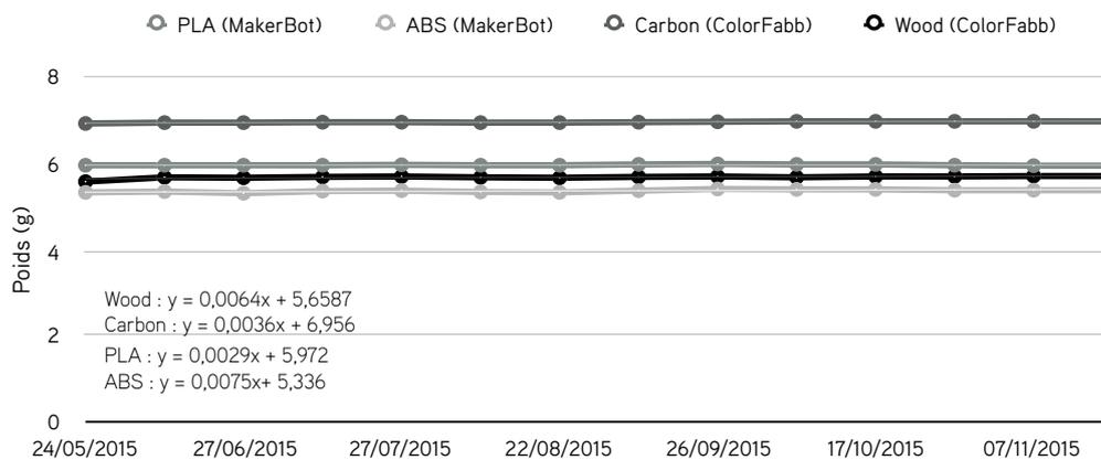
FIGURE 17 – Relevés du test d'exposition aux ultraviolets
